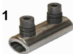
1 25-150 mm 2 Cu/Al Skjøtehylse med 2 knekkpunkt Verktøy: Unbrako 6 mm
