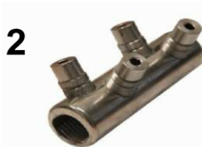
2 50-240 mm 2 Cu/Al Skjøtehylse med 2 knekkpunkt. Verktøy: Unbrako 8 mm
