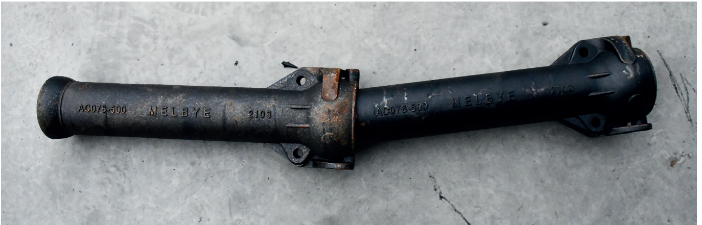
Ledd i rør kan bøyes 15 grader.
