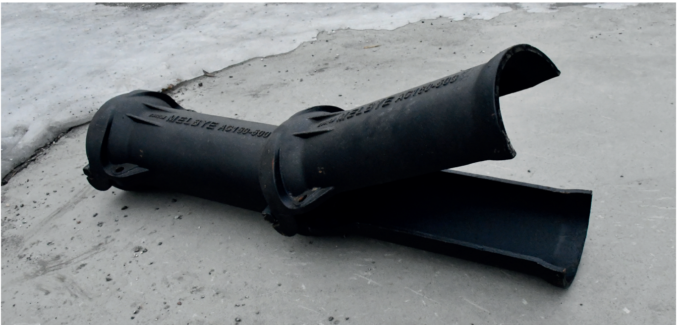
Kabelvernør leveres i lengder a 1 meter. 1 stk består av 4 halvrør som hengsles i hverandre. Rørene låser seg i skjøt og man trenger kun å bolte i ender av røret.
