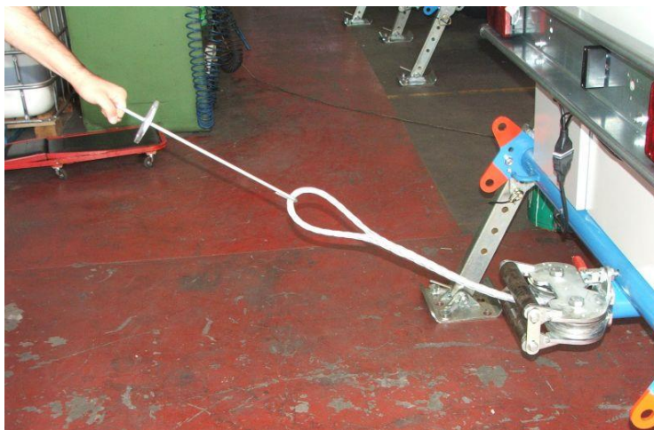
Fig. 1 – Manuell stramming av wiren
